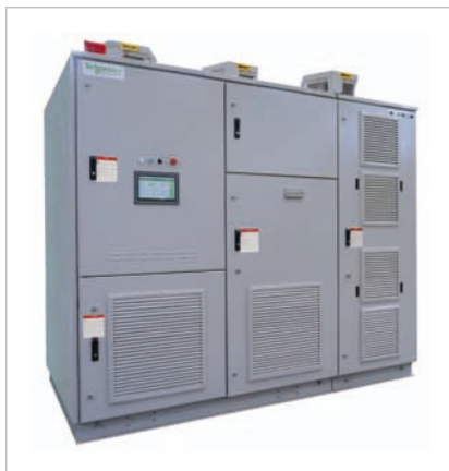
Už v základe sú frekvenčné meniče Altivar 1200 vybavené vstupným transformátorom a výkonovými modulmi s nízkonapäťovými IGBT tranzistormi.
