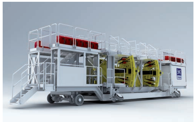
Významný technický počin – vŕtacia súprava Crossrail zložená z dvoch strojných častí – sa posúva tunelmi a vŕta do tunelovej obmurovky viac ako 250 000 otvorov.
