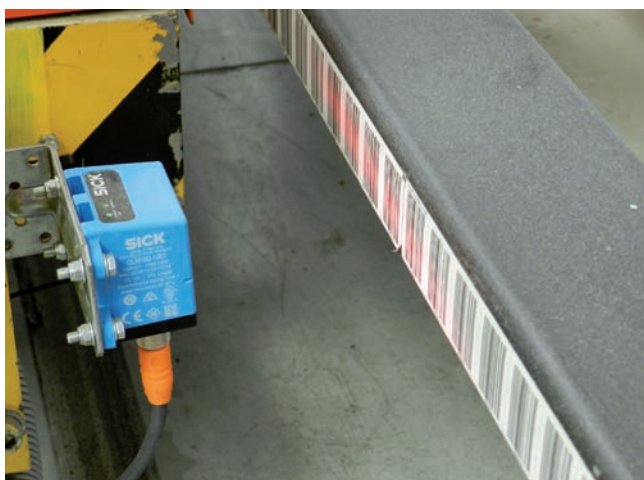
Skener umiestnený na vozíku sníma čiarový kód, čím je určená poloha vozíka s presnosťou na 1 mm.
