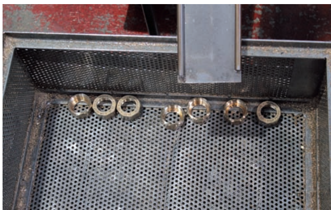
Opracované výkvyky spúšťané do záchytnej debničky cez kontrolnú sklzovú dráhu
