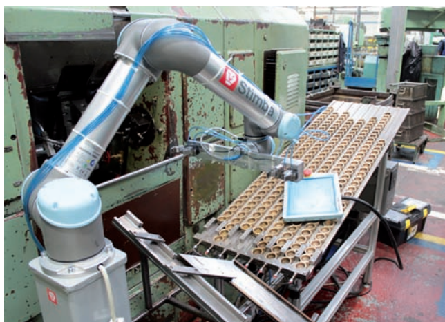
Zostava na opracovanie mosadzných výkovkov – robot UR5, zásobník výkovkov a stroj na opracovanie VAGON
